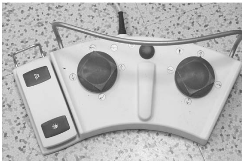
Obr. 3. Ovládanie hlavných funkcií zariadenia je možné robiť priamo počas výkonu operatérom pomocou multifunkčného nožného spínača, ktorým sa nastavuje poloha pacienta (ľavý a pravý veľký okrúhly spínač), zapína sa skiaskopia, resp. robí sa RTG záznam do pamäte počítača (pedálový spínač s vyznačenými funkciami RTG záznamu), prepínanie obrazu na ľavom monitore s možnosťou výberu RTG, sonografického, alebo urodynamického záznamu sa robí pomocou malého okrúhleho nožného spínača. Umiestnenie prepínačov je ergonomické s ľahkou orientáciou počas výkonu. Okrem toho sa celé zariadenie môže ovládať manuálne priamo v operačnej miestnosti, alebo z riadiaceho a dokumentačného centra.
