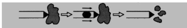
Obr. 15 Swis Litoklast je zariadenie pracujúce na princípe pneumatickej zbijačky. Stlačený vzduch privádzaný do rukoväte, ktorá má tvar kovového válc, rozkmitá "projektil" vo vnútri. Pohyb projektilu je prenášaný na hrot pneumatickej sondy, ktorý sa prikladá na kameň ( Rajmon, 2001).
