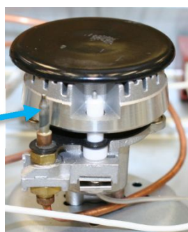
Bezpečnostná poistka „Stopgaz“
