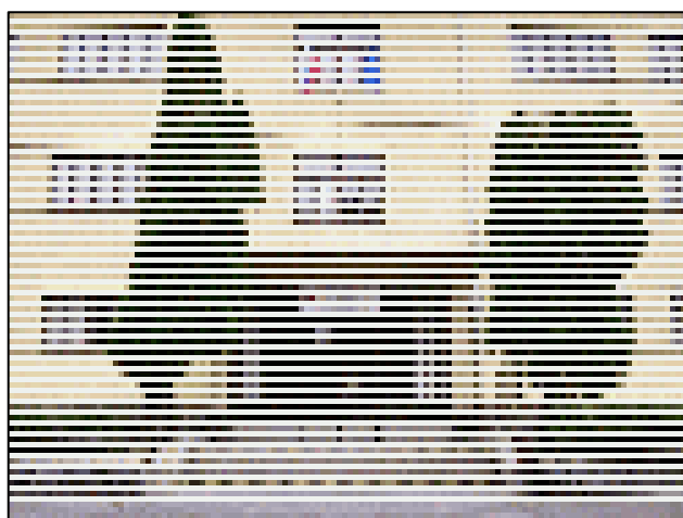
Obr. 66 PÁRNA A NEPÁRNA POLOSNÍMKA VYTVÁRAJÚ KONEČNÚ SNÍMKU
